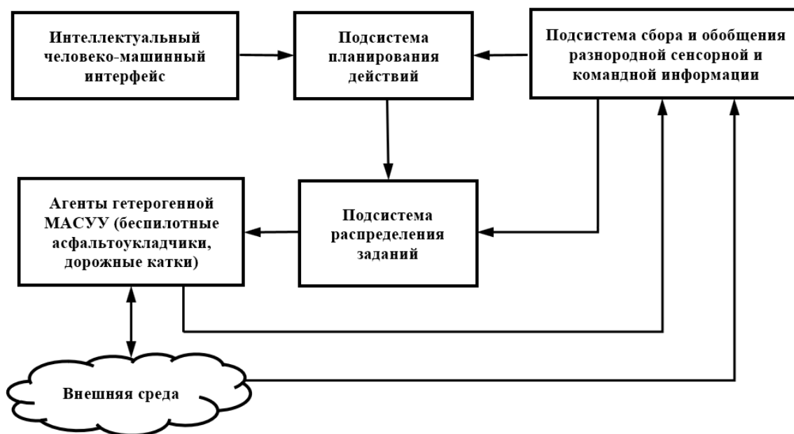
Рис. 2. Функциональная схема структуры гетерогенной МАСУУ
