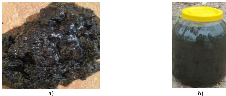
Рис. 2. Пробы для анализов естественный поля фильтрации: а) пробы из осадка дна поля фильтрации; б) пробы производственных стоков
