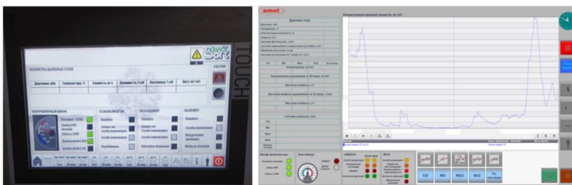
Рис. 6. Общий вид разработанного программного обеспечения системы «Софт:Сигнал»-Ш-С-СИ v.Есо с системами жизнеобеспечения на базе промышленных контроллеров
