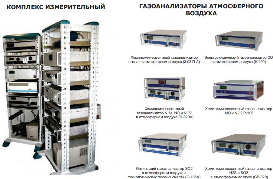
Рис. 5. Общий вид поста мониторинга и его наполнение
