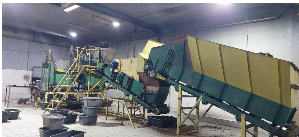
Рис. 4. Линия инокуляции и фасовки блоков тоннельного субстрата в чистой зоне
