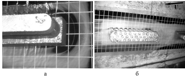
Рис. 3. Эволюция размыва контрастного покрытия при угловом обтекании двух мостовых переходов: а) t = (9 - 12) минута, б) t = (12 - 15) минута
