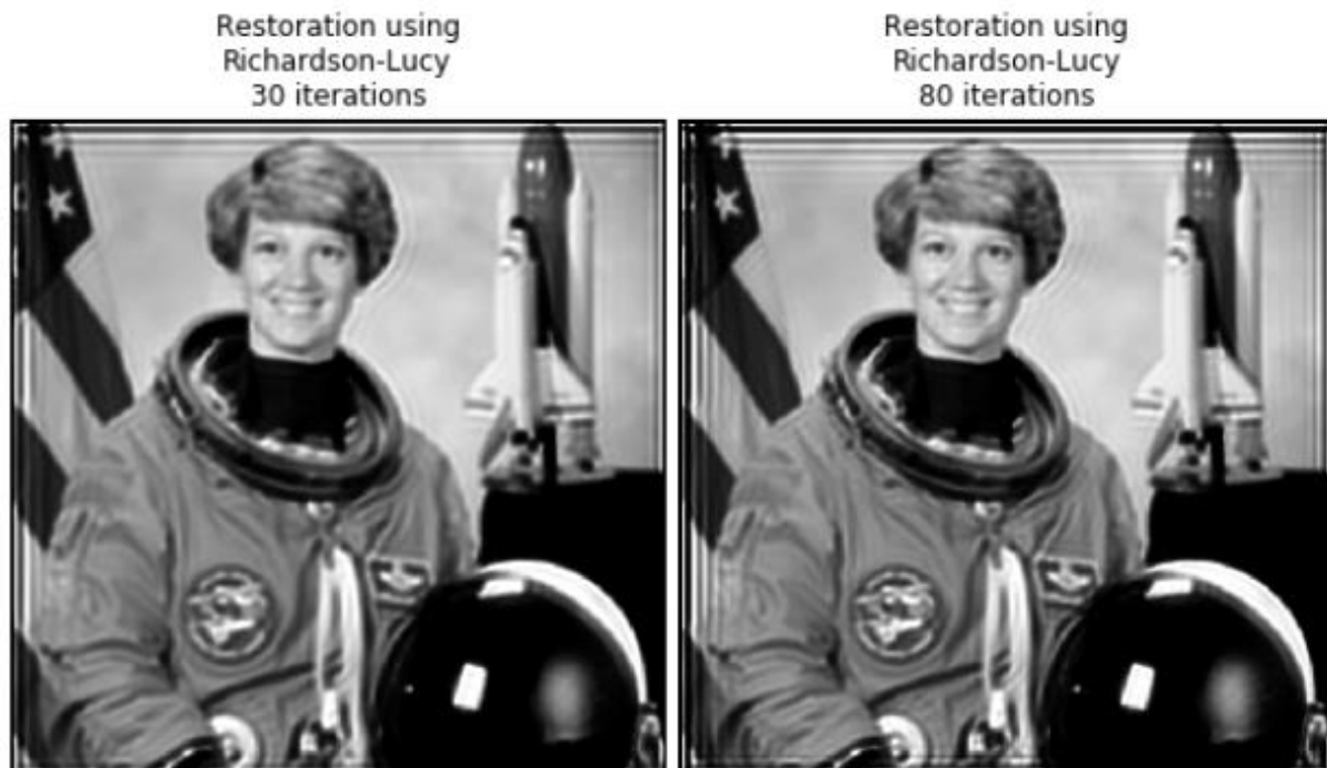
Рис. 9. Результат удаления размытости изображения при помощи подхода Ричардсона-Люси в 30 и 80 итераций
