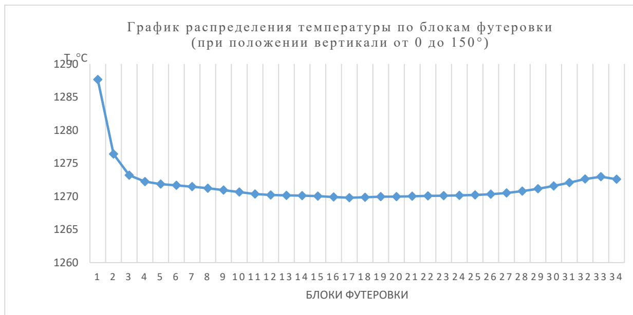
Рис.4. График распределения температуры по блокам футеровки (при положении вертикали от 0 до 150°)
