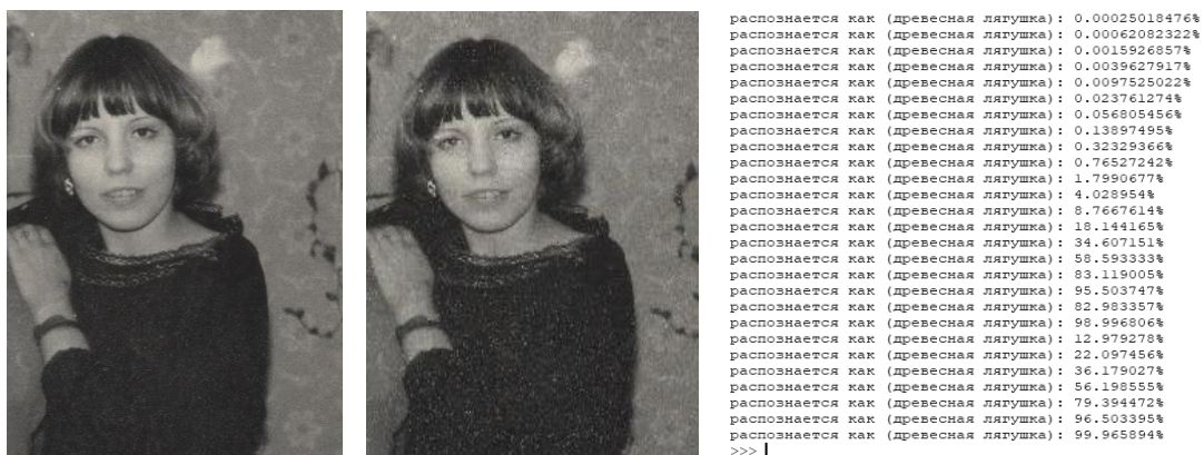
Рис. 2. Слева – исходное изображение, распознаваемое нейронной сетью MobileNet, как «девушка», в центре – сгенерированное алгоритмом GDWN изображение, распознаваемое нейронной сетью, как «древесная лягушка», справа – процесс преобразования изображения
