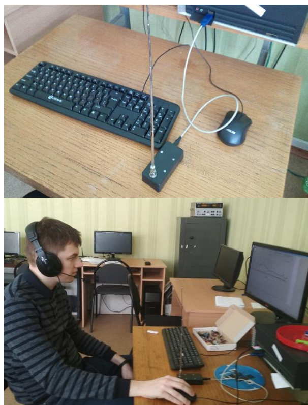
Рис. 2. Внешний вид сканирующего приемника, подключенного к персональному компьютеру и процесс обнаружения оператором несанкционированных радиоизлучений
