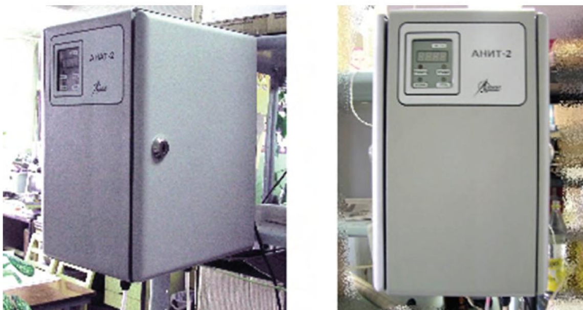
Рис. 2. Стационарная береговая автоматическая станция многокомпонентного контроля качества сточных вод
