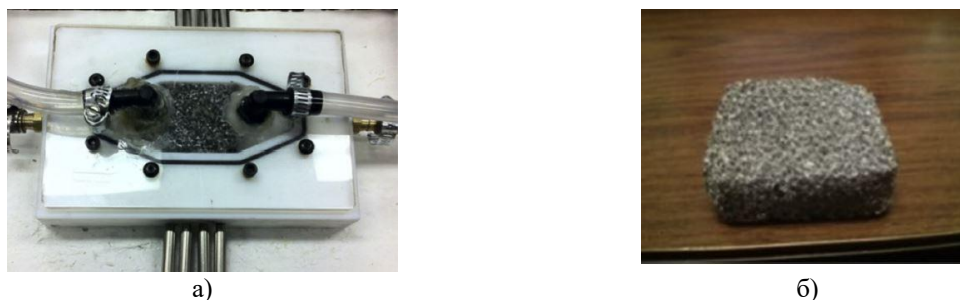
Рис. 12. Охлаждение для процессора Intel Core i7 [30]: а) тестовый теплообменник б) радиатор из алюминиевой пены
