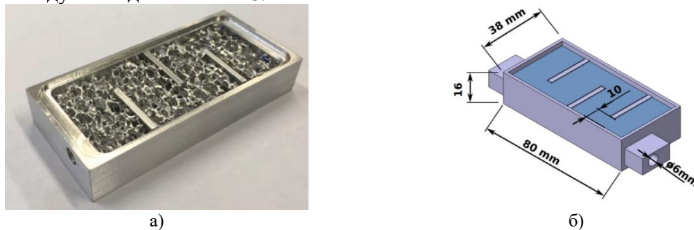
Рис. 11. Теплообменник для низкотемпературного охлаждения электроники средней плотности [29]: а) внешний вид теплообменника б) основные геометрические параметры
