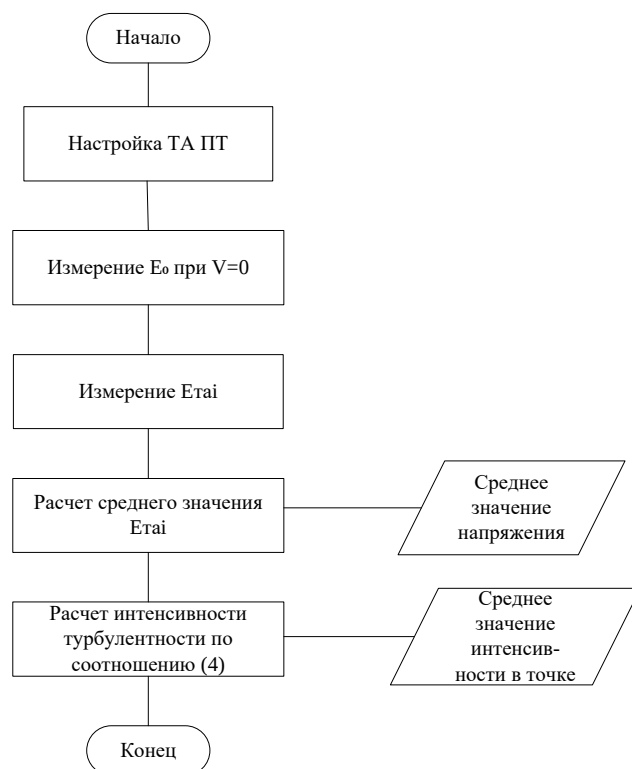
Рис. 1. Алгоритм измерения интенсивности турбулентности по упрощенной методике градуировке датчика термоанемометра в 1 точке потока
