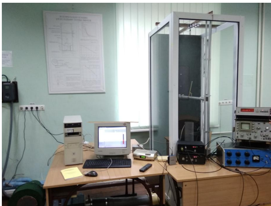
Рис. 2. Стенд для исследования вертикальной затопленной струи с положительной плавучестью
