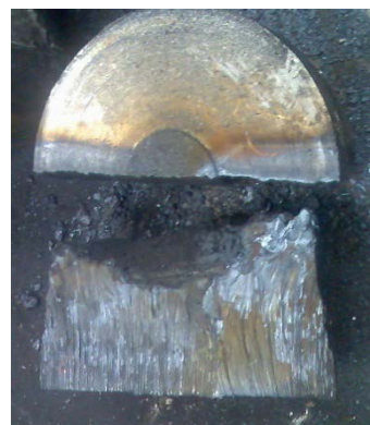
Рисунок Б.4 – Усадочные раковины в 8-ми заготовочных слитках колесной стали
