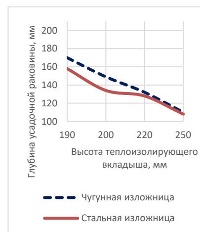
Рисунок 4.6 – Изменение глубины усадочной раковины от высоты вкладыша (расчет): Общее время отливки слитка: а - 10 мин, б – 12 мин, в – 14 мин, г – 16 мин, д – 18 мин
